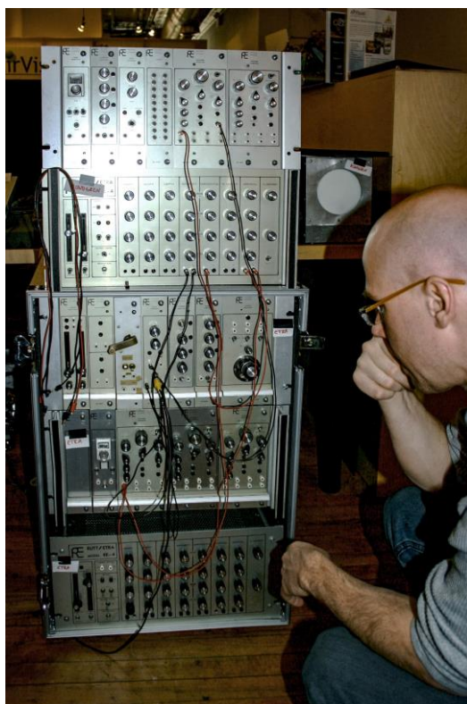
Figura 2: Sintetizador analógico modular Rutt/Etra.
